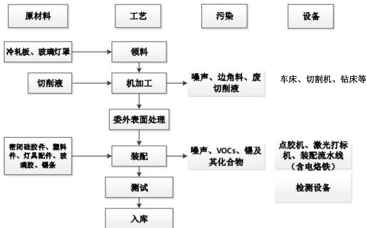
图3.4-1 生产工艺流程及产污环节图
