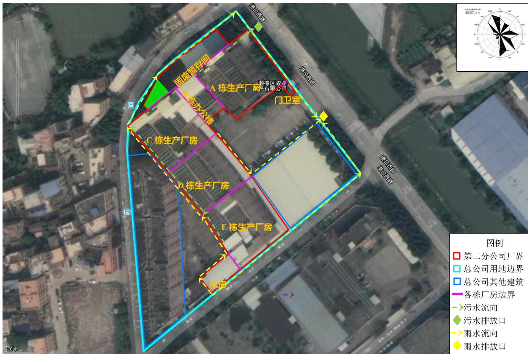
图4.1-2 全厂废水及雨水流向示意图
